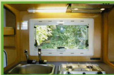
基本option設定時には、2つの蛇口。シンク下のポリタンクからの清水用と、大型タンク(シート下)の生活用水用とに分けてあります。
