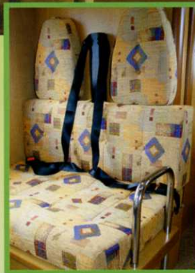
サードシートには3点式シートベルトを採用。チャイルドシートの取付けにも対応できます。ひじ掛けパイプも便利です。
